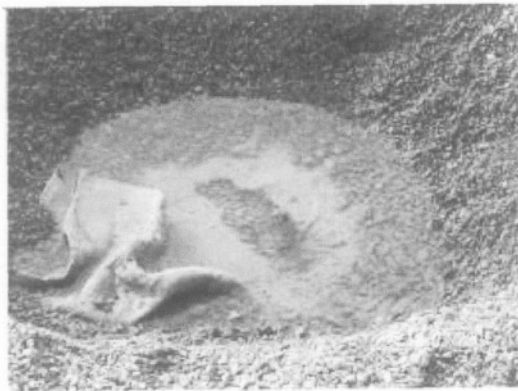
图 4 香港迪斯尼水上乐园防渗土工膜渗漏检测找到的破损孔洞
